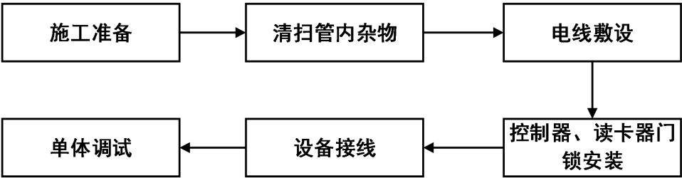
图 4.4-4 门禁箱体施工工艺流程图
