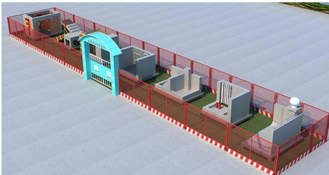
场地尺寸确定好之后，决定放哪几种质量样板设备，一般的样板区至少要制作 6 个样板以上。建筑施工质量样板展示区主要包括主体结构样板、砌体抹灰样板、楼梯样板、厨卫样板、屋面样板、电气预埋样板、给排水井样板、水井电气预埋样板、幕墙石材干挂样板、卫生间同层排水、基础样板、装饰抹灰样板、地下室样板、独立柱样板等数十种样板展示区，根据具体需要自由组合。
