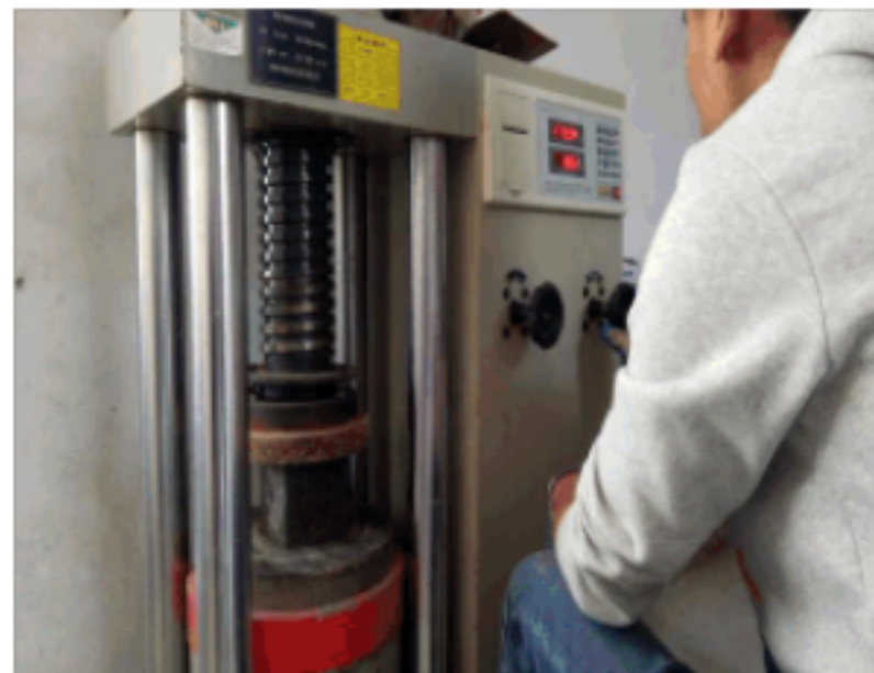
图 3-6 试块抗压强度试验
