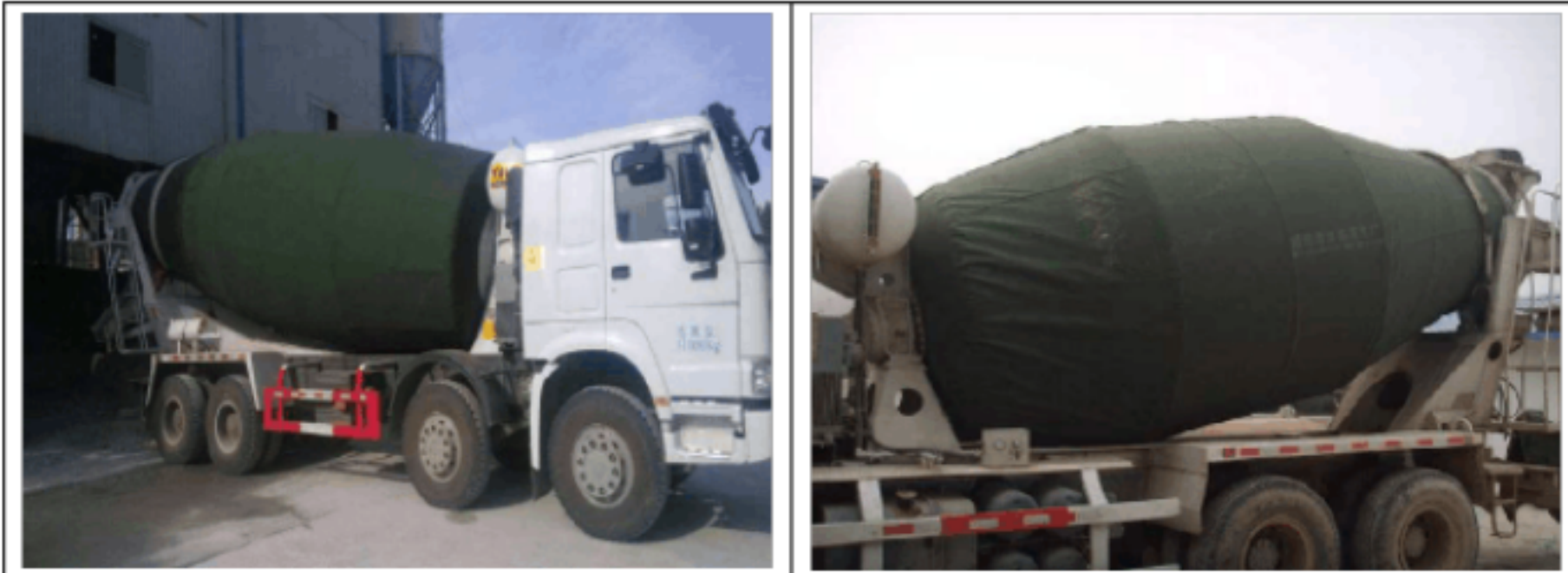
图 4-1 混凝土运输车保温措施
