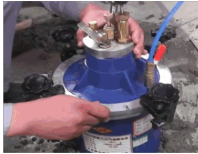
图 3-4 混凝土含气量检测
