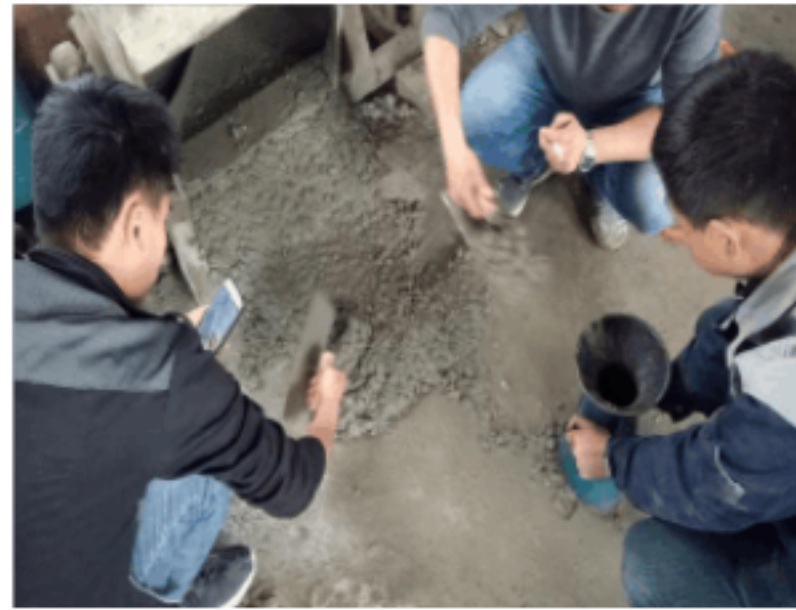
图 3-2 混凝土坍落度检测
