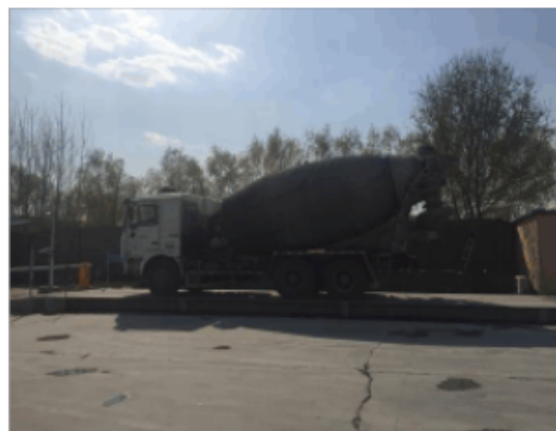
图 3-10 混凝土过磅出厂
