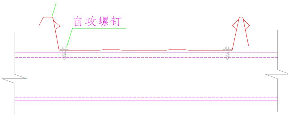
③、复查支座码位置：用目测的方法检查每一列支座码是否在一条直线上，如发现较大偏差的支座码，在屋面板安装前一定要纠正，直至满足板材安装的要求。
