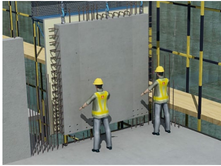
两名专业操作工人手扶引导降 用专用目视镜观察钢筋对孔
