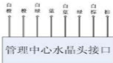
其中单元主机与联网控制器、管理中心机相连接的时候，只用到其中的四条线：绿、白绿、蓝、白蓝。接线的时候，单元主机的接线颜色与联网控制器、管理机的颜色必须相对应。如果用万用表测量的时候，单元主机的绿色与管理中心机的水晶头的绿色相通，白绿与白绿相通，蓝与蓝相通，白蓝与白蓝相通即可。如不通，既接线有错误，或者接线本身有断路。
