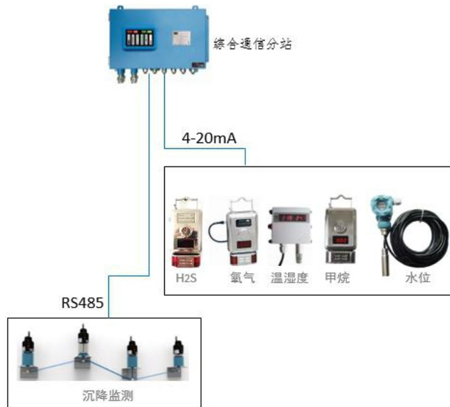
综合管廊环境监测设备连接示意图
