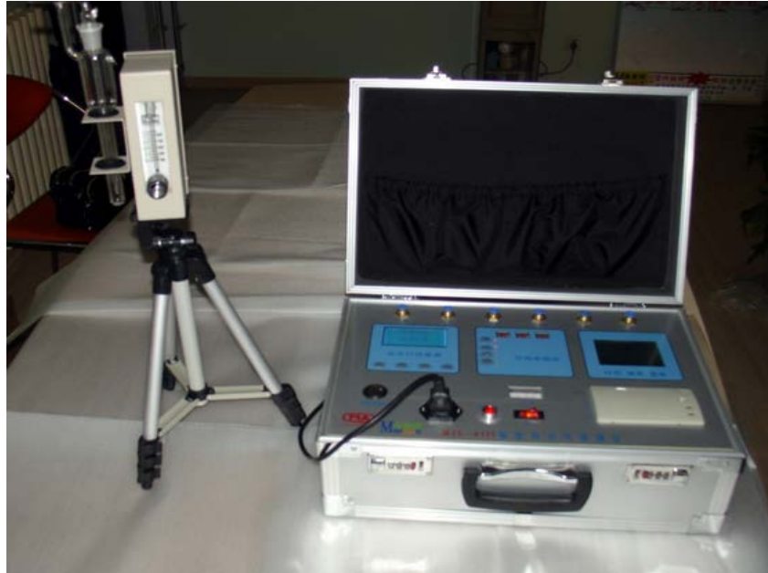
图 18.1-26 室内空气质量监测仪
