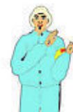
10、“微动范围” 双小臂曲起，伸向一侧，五指伸直，手心相对，其间距与负载所要移动的距离相接近。
