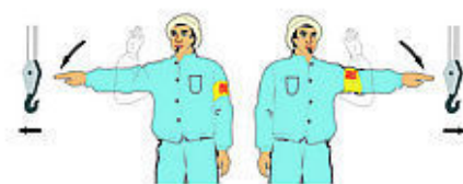
6、“吊钩水平移动” 小臂向侧上方伸直，五指并拢手心朝外，朝负载应运行的方向，向下摆动到与肩相平的位置。
