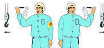
9、“吊钩水平微微移动” 小臂向侧上方自然伸出，五指并拢手心朝外，朝负载应运行的方向，重复做缓慢的水平运动。
