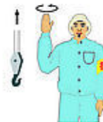
4、“吊钩上升” 小臂向侧上方伸直，五指自然伸开，高于肩部，以腕部为轴转动。
