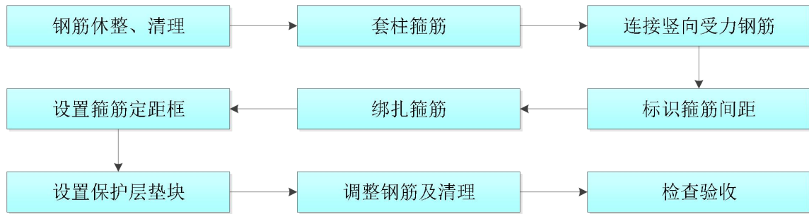
图 1.1.1-6 柱钢筋绑扎工艺流程
