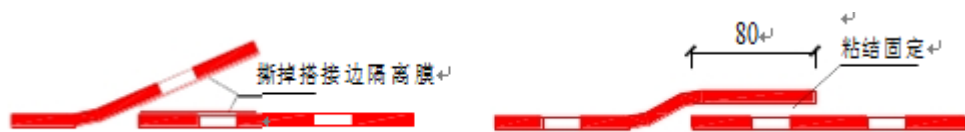
图 5.3 防水卷材搭接边粘贴示意图
