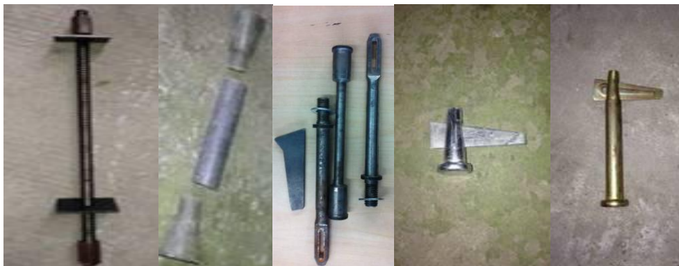
4. 辅件：螺杆、PCV 套管、(三段式螺杆)、模板销钉销片、螺杆
