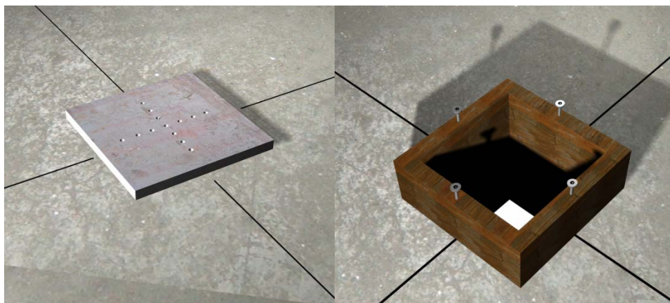
\pm 0.000\text{m} 楼面激光控制点点位做法
