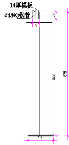
内侧转角上口立模钢筋支架
