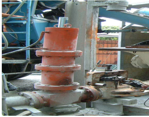
图 4.4 液压截止阀示意图
