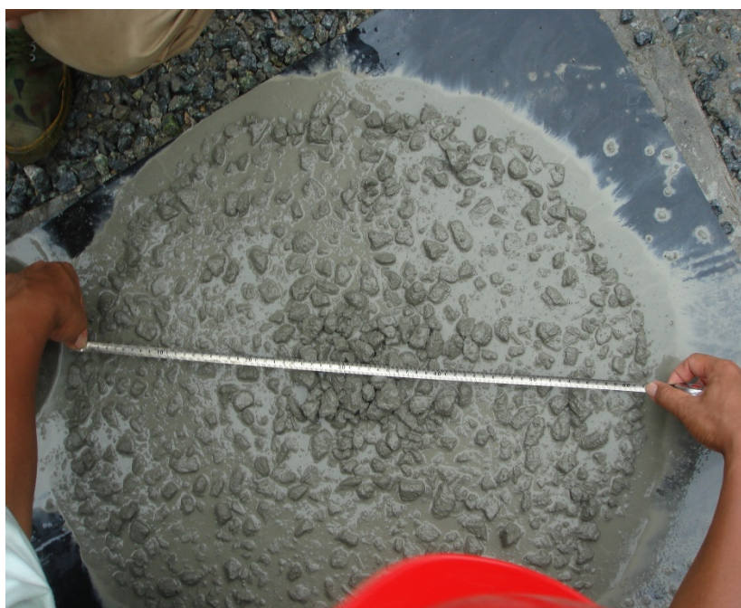
图 3.1 混凝土扩展度测量示意图
