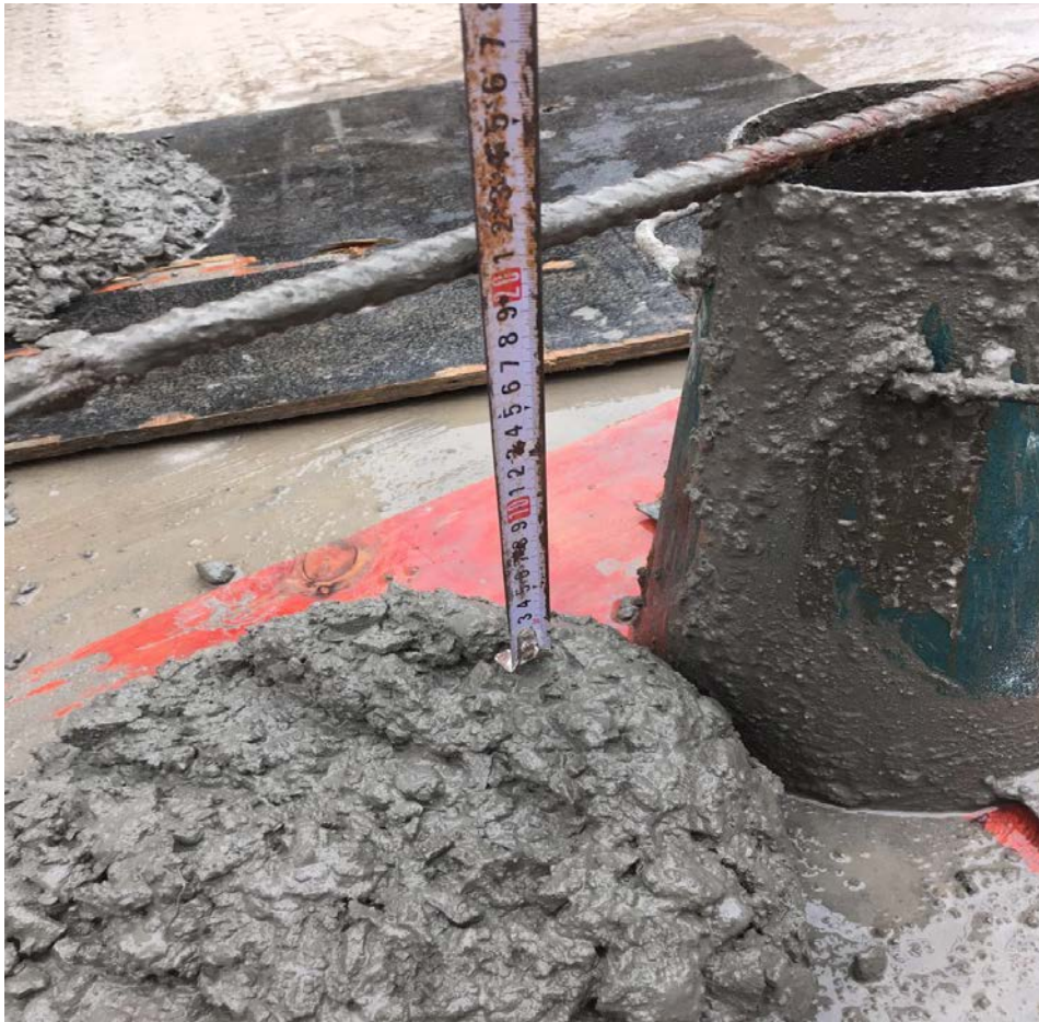
现场塌落度检测
